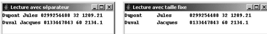
Figure 7.9 — Lecture de données dans un fichier de type texte, les champs étant délimités par un séparateur ou de taille fixe.
